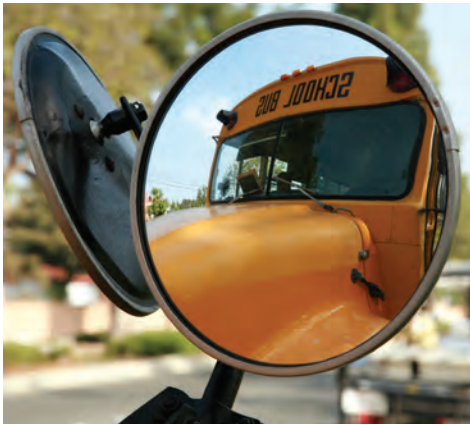
الشكل (6) المرآة المحدبة على جانبي السيارة
